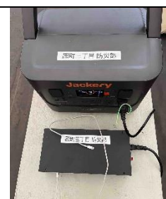
携帯用蓄電池
